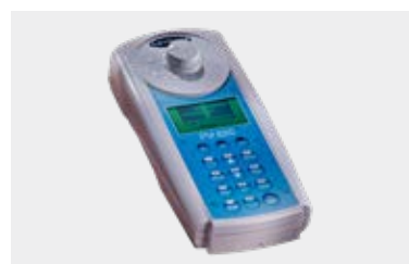
PHOTOMÈTRE PM 620 Réf 46612 : Étanche IP68. 34 paramètres. Plus d'infos sur notre site www.lascolaire.fr
